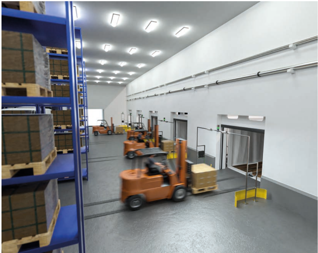
Abb. 8: Gate-Applikation in der Logistik: Alle Datenträger auf der Palette werden während der Durchfahrt durch das Gate identifiziert
