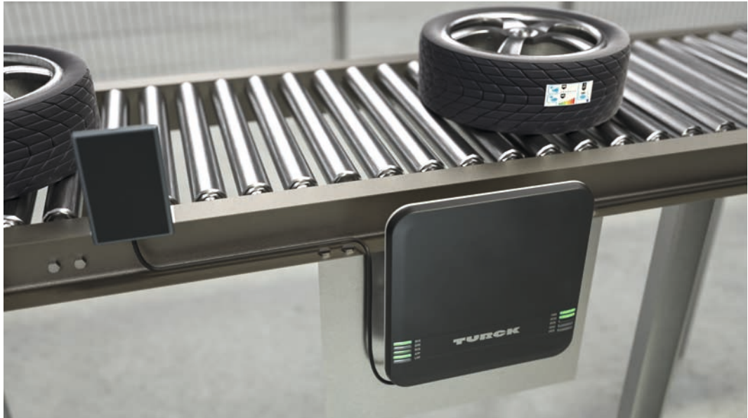
Abb. 15: Beispiel: Identifikation einzelner Produkte auf einem Förderband
