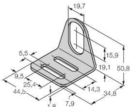
Befestigungswinkel für Gewinderohrsensoren; Werkstoff: Edelstahl A2 1.4301 (AISI 304)
