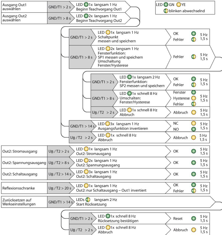
Das erfolgreiche Einlernen wird mit schnell blinkender grüner LED angezeigt. Danach ist der Sensor automatisch im Normalbetrieb. Bei einem erfolglosen Einlernen reagiert die LED mit wechselnder grüner und gelber Anzeige. Im Normalbetrieb signalisieren die beiden LED's den Schaltzustand von Ausgang 1 des Sensors.
