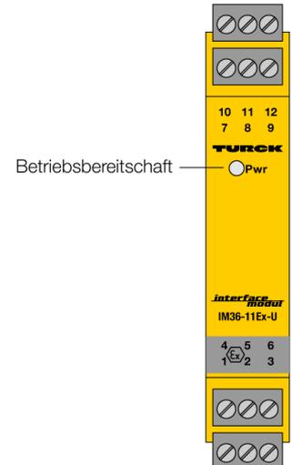
Über den 1-kanaligen Potentiometerverstärker IM36-11EX-U/24VDC werden Signale von Potenziometern in 3/5-Leiter-Schaltung galvanisch getrennt aus dem Ex-Bereich in den Nicht-Ex-Bereich übertragen und in normierte Analogsignale von 0...10 V umgewandelt. Der Widerstandswert des Schleiferabgriffes wird von 0 Ω bis zum Nennwiderstandswert (Endwert) des Potenziometers erfasst und linear verarbeitet.
