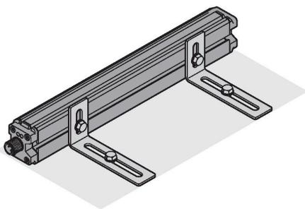
Una amplia gama de accesorios de montaje permite múltiples opciones de instalación. Condicionado por el principio de medición, basado en un principio operativo de un acoplamiento RLC, el sensor de posición lineal es inmune a piezas de hierro imantadas y a otros campos de perturbación.
