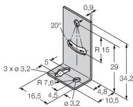
ángulo de montaje; material VA 1.4401, para optosensor modelo Q12
