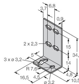
ángulo de montaje; material VA 1.4401, para optosensor modelo Q12
