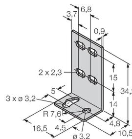
équerre de montage, matériau VA 1.4401, pour le détecteur photoélectrique du format Q12
