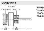
Ультразвуковой датчик, датчик режима диффузии, диапазон 3 м, последовательный интерфейс для подключения к узлам DX80
