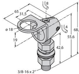
Монтажный кронштейн, VA 1.4401, для резьбы M10 x 1.5, длина резьбы 18 мм
