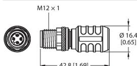
Согласующий резистор для защитного RFID-переключателя
