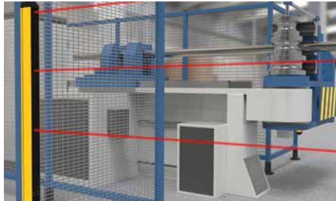
2, 3 또는 4개의 빔이 있는 SGS 안전 그리드 시스템은 작업 영역의 돌레를 모니터링 하는데 사용됩니다.
