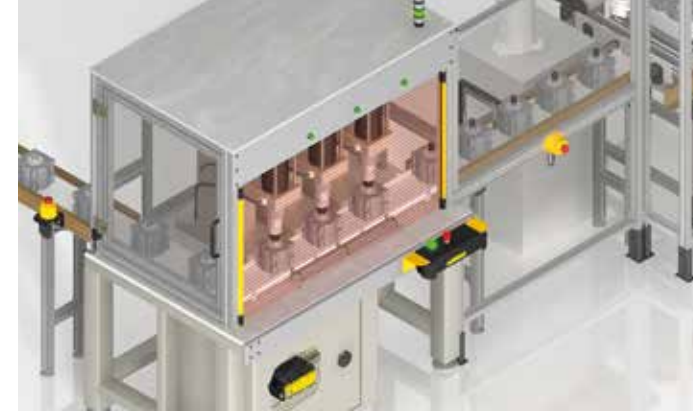
비상 정지 버튼, 안전 스위치, 안전 라이트 커튼, 양손 컨트롤 및 로프 풀 스위치와 같은 다양한 안전 장치가 모니터링됩니다.
