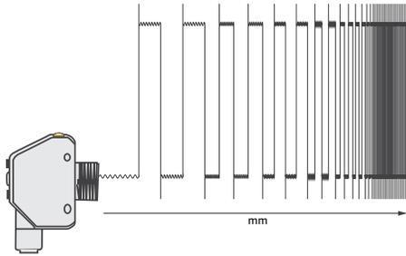
Pulse Pro를 통해 PFM 출력이 포함된 점점 센서가 실시간 측정 및 위치 데이터가 있는 아날로그 센서처럼 작동할 수 있습니다
