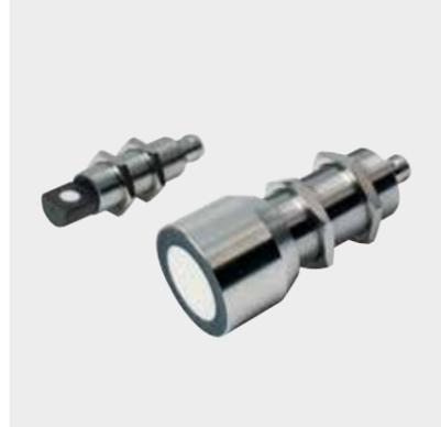
이 시리즈는 아날로그 출력 외에도 스위칭 범위가 항상 아날로그 출력의 설정된 측정 범위 제한을 따르는 특정 스위칭 출력을 제공합니다. 초기 설정에서 센서는 전체 측정 범위에서 0...10 V 또는 4...20 mA의 출력 신호를 제공합니다. 측정 범위는 티칭 어댑터 또는 컨트롤러를 통해 개별적으로 설정 가능합니다. 또한 스위치로 사용할 때, 전환 지점을 개별적으로 정의할 수 있습니다.
