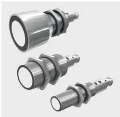
방폭 지역에서도 사용이 가능하도록, 하이엔드 시리즈는 다양한 적용 조건에 맞게 광범위한 원통형 디자인을 제공합니다. 투수광 모드, 역반사 또는 투수광 모드 작동이 가능하며, 상호 간섭으로부터 보호하기 위해 여러 센서의 동기화 기능이 가능합니다. 필요한 경우, IO-Link를 통해 프로세스 값을 직접 전송하거나 설정을 변경할 수 있습니다. 일반적으로 스위칭 출력을 통해 물체 존재 유무를 확인하고 아날로그 출력으로 거리를 확인합니다. 또한 온도 보상 기능으로 정확성을 높입니다.
