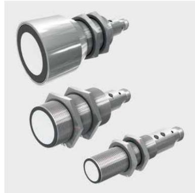
하이엔드 시리즈는 까다로운 조건에서도 보편적으로 적용할 수 있는 가능성을 제공합니다. 직접 반사형 모드, 역반사 또는 투수광 모드 작동이 가능하며, 상호 간섭으로부터 보호하기 위해 여러 센서의 동기화가 가능합니다. 필요한 경우, IO-Link를 통해 프로세스 값을 직접 전송하거나 설정을 변경할 수 있습니다. 일반적으로 스위칭 출력을 통해 물체 존재 여부를 확인하고 아날로그 출력으로 거리를 확인합니다. 또한 온도 보상 기능으로 정확성을 높입니다.
