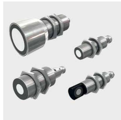
스탠다드 시리즈는 M18 및 M30 버전으로 제공되며 독립적으로 조정 가능한 두 개의 스위칭 출력을 제공합니다. 스위칭 출력은 외부 티칭 어댑터 또는 내장 버튼을 통해 센서에서 직접 파라미터 설정이 가능합니다. 추가 설정 옵션으로 장치를 역반사형 모드로 사용하거나 히스테리시스를 어플리케이션에 맞춰 조정할 수 있습니다. 해당 시리즈의 감지 범위는 최대 600cm입니다.
