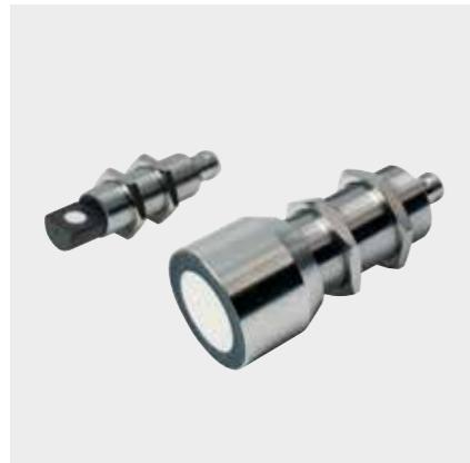
이 시리즈는 아날로그 출력 외에도 스위칭 범위가 항상 아날로그 출력의 설정된 측정 범위 제한을 따르는 특정 스위칭 출력을 제공합니다. 초기 설정에서 센서는 전체 측정 범위에서 0...10 V 또는 4...20 mA의 출력 신호를 제공합니다. 측정 범위는 티칭 어댑터 또는 컨트롤러를 통해 개별적으로 설정 가능합니다. 또한 스위치로 사용할 때, 전환 지점을 개별적으로 정의할 수 있습니다.
