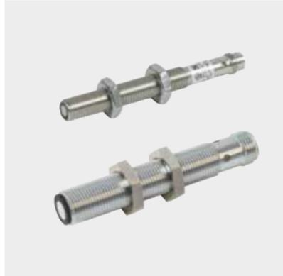
M8 나사산 하우징에서 가장 작은 초음파 센서는 총 4가지 버전으로, 각각 PNP 또는 NPN 인터페이스가 있는 screen 또는 barrier입니다. 센서의 측정 범위는 100 mm이며 블라인드 존은 20mm입니다.
