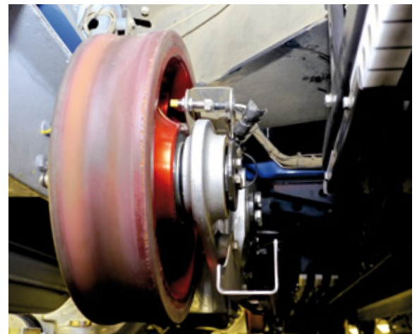
메가코스터의 바퀴 홀에 터크의 Uprox+ 근접센서가 설치되어 안정적으로 작동된다.
