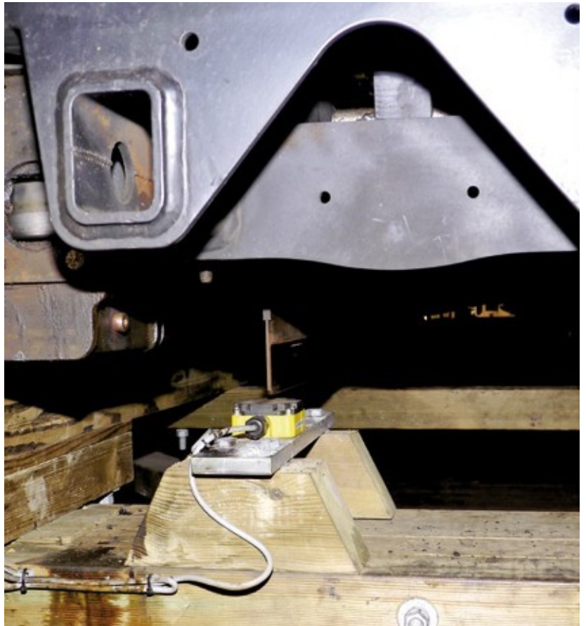
터크의 Uprox+ 센서 위 우든 팀버 코스터 캐리지의 구리 브레이크 핀
